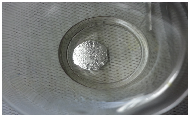
Fig 2.7: Processo del lift – off: campione di ossido di Zinco (ZnO) in acetone.
